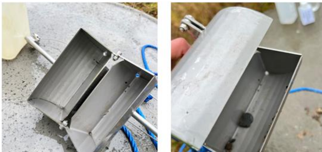
Figur 3: Van Veen Grabb for uttak av sedimentprøver i kum.
