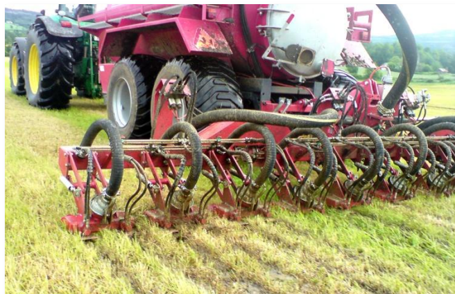
DIREKTE INNSPRØYTING: DGI skyter husdyrgjødsla ned i grasskorpa ved hjelp av høyt trykk. Det finnes også ulike typer nedfellere med rulleskjær (Foto: Stein Jørgensen, Hedmark Landbruksrådgiving)
