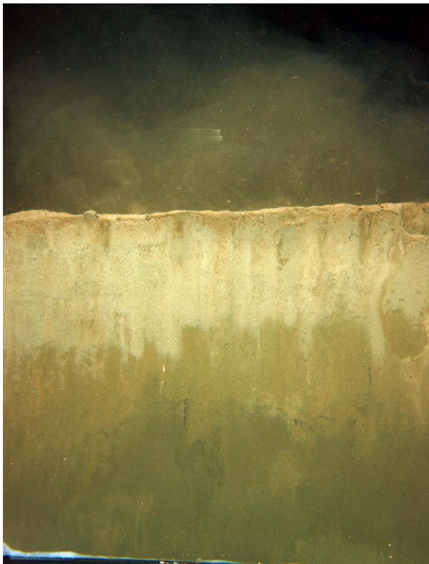
Figur 25. Snitt ned i sedimentet fotografert med NIVAs SPI-kamera. Bildet viser opprinnelig sjøbunn i Ormefjorden dekket med et lag ren leire. Tildekkingslaget varierer mellom ca 2 og 5 cm. Foto: Bjørnar A. Beylich, NIVA.
