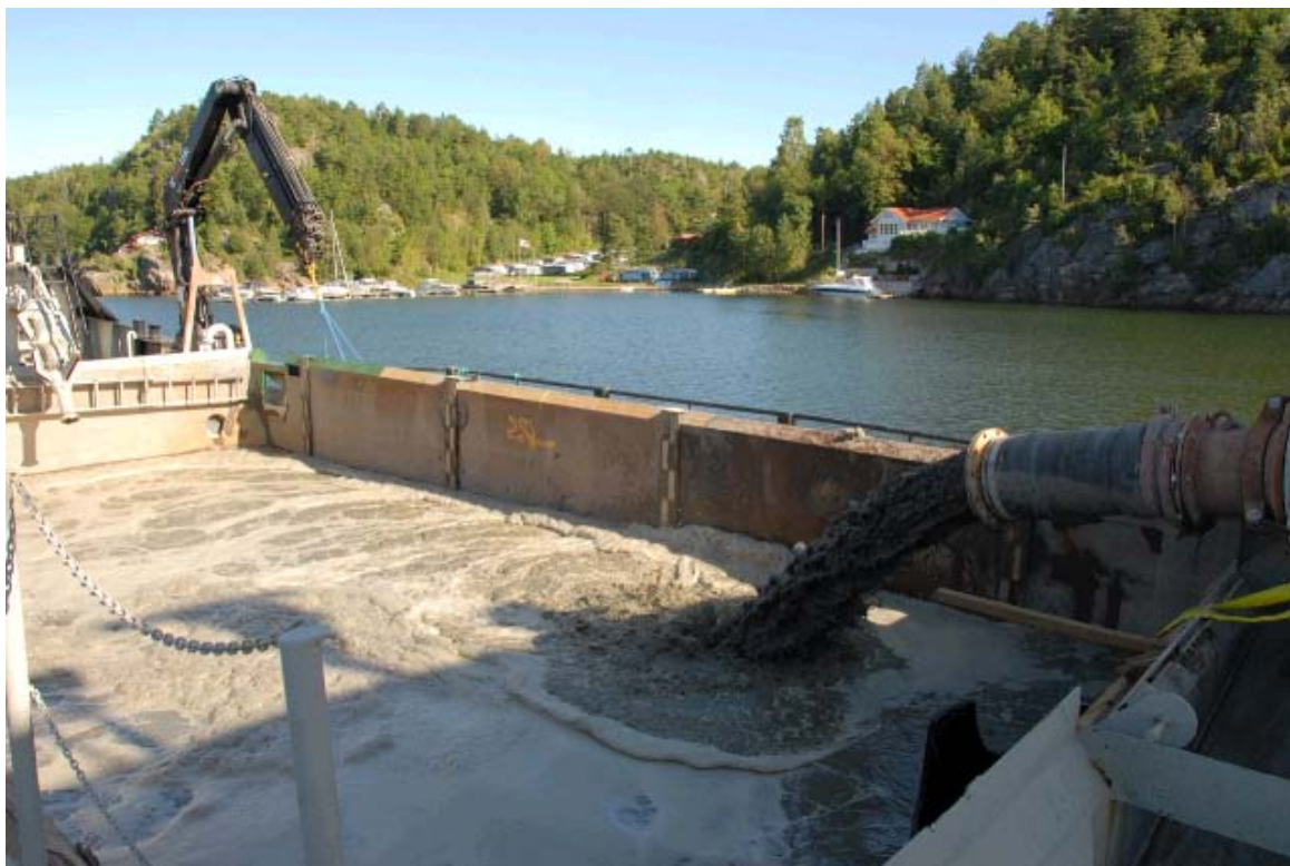
Rein leire sugemudres til lasterommet i Agder Marines sugemudringsfartøy Arena.
