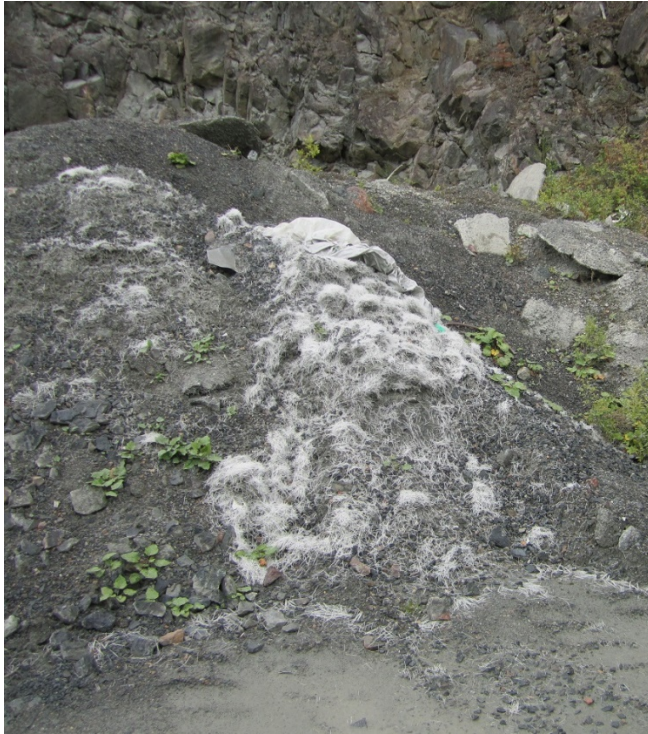
Masser med plastarmering etter tidligere betongproduksjon fra før 2012. (Foto: Fylkesmannen i Oppland.)
