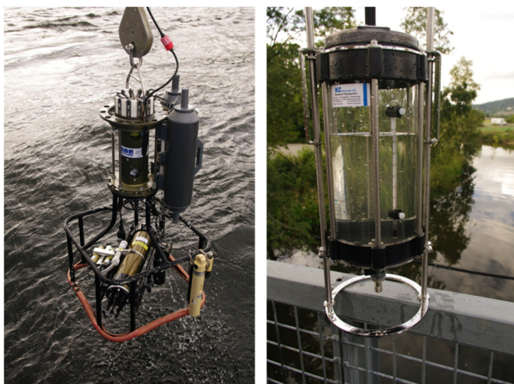
Figur 5 a og b. Niskin rosett vannhenter med CTD (venstre) og Ruttner vannhenter (høyre).
