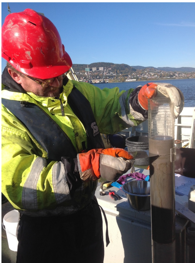
Figur 10. Oppdeling av kjernene i 0-5 cm og 5-10 cm om bord på F/F Trygve Braarud.
