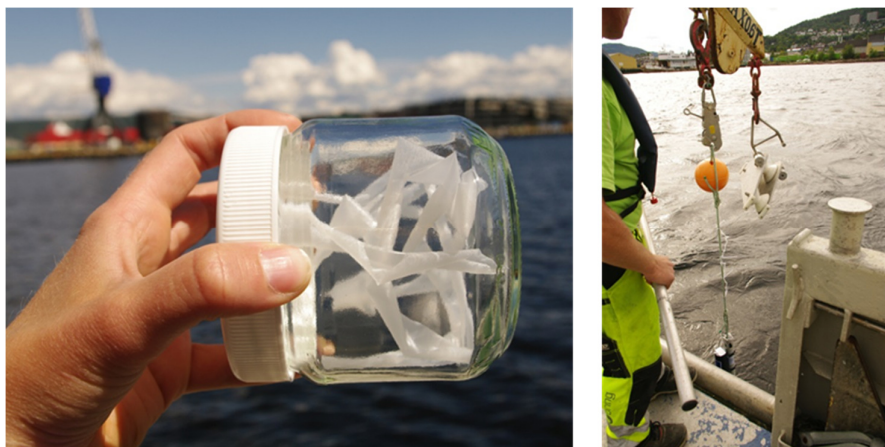
Figur 6 a og b. POM i oppbevaringsglass før utsetting på 14 stasjoner i Drammensfjorden (venstre) og plassering av POM mellom transponder og blåse (høyre).
