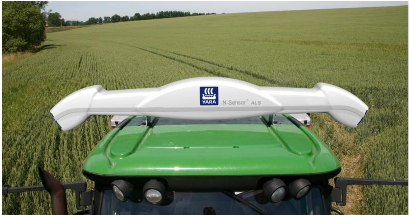
Foto: Sensor for optisk klorofyllmåling, i kombinasjon med GPS-styring av innstillingene på gjødselspreder eller åkersprøyte, gir miljøgevinster (foto: Yara)
