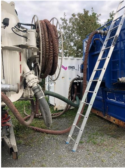
Figur 8: Polymerdosering skjer i avvanningsenhet (hvit container) plassert ved siden av avvanningscontainer. Bilder: Rambøll (venstre), Innherred Renovasjon (høyre).
