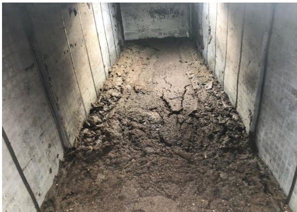
Figur 9: Innsiden av en avvanningscontainer før påfylling (venstre) og rett etter påfylling (høyre). Silduk omgir tankvolumet. Bilde: Rambøll (venstre), Innherred Renovasjon (høyre).
