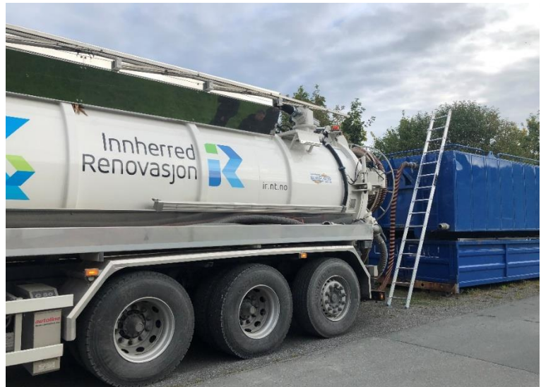
Figur 7: Tømming av slamtømmebil til avvanningscontainer i Malvik. (Bilde: Rambøll).
