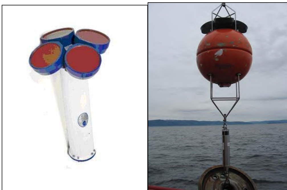
Figur 2.1. 75 kHz ADCP. Selve instrumentet (til venstre) og omhyllet i oppdrift klar til utsetting (til høyre). Under ADCPen henger en akustisk utløser (for opptak) og bunnforankringen (jernbanehjul).
