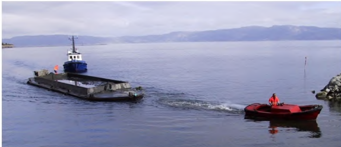
Trondheim Havns splittlekter (volum 150 m 3 ) under slep for dumping av mudringsmasser (foto: GeoSubSea AS)
