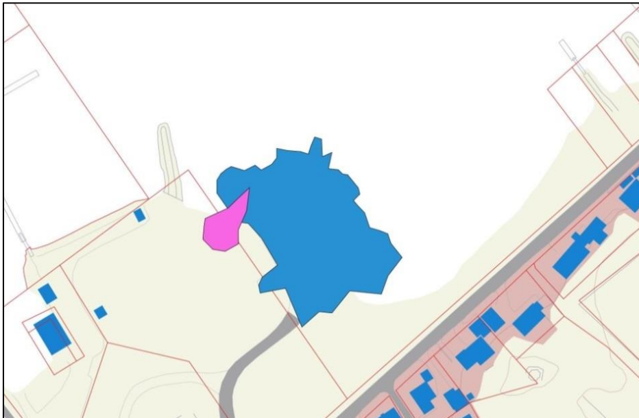
Figur 4. Uthaug havn, forurenset område. Området som er påvirket av sementslam er markert med blått. Arealet av området er ca. 6.000 m 2 . I området markert med rødt er det tidligere registrert plastsøppel har areal på ca. 150 m 2 .
