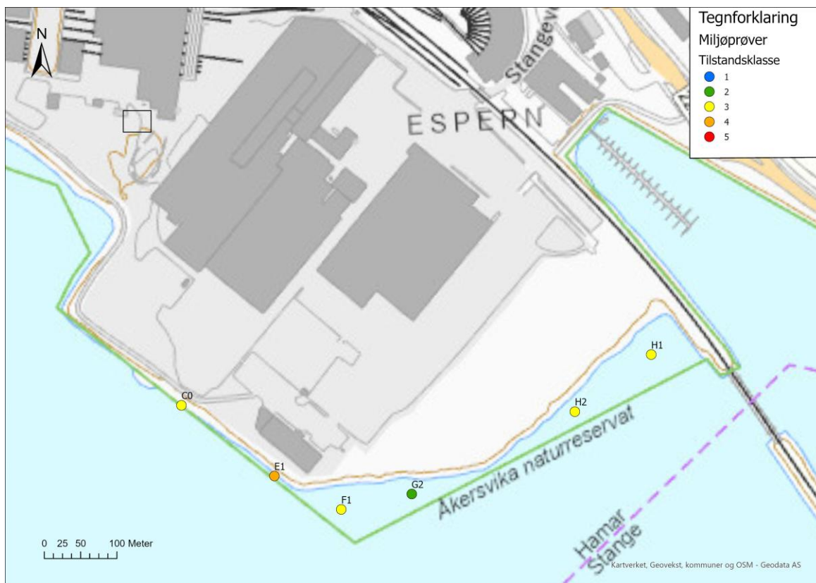
Figur 2-2: Illustrasjon av tiltaksområdet ved Espern, plassering av prøvestasjoner og påvist tilstandsklasse iht. veileder M-608/2016 rev. 2020 (målestokk 1:500).
