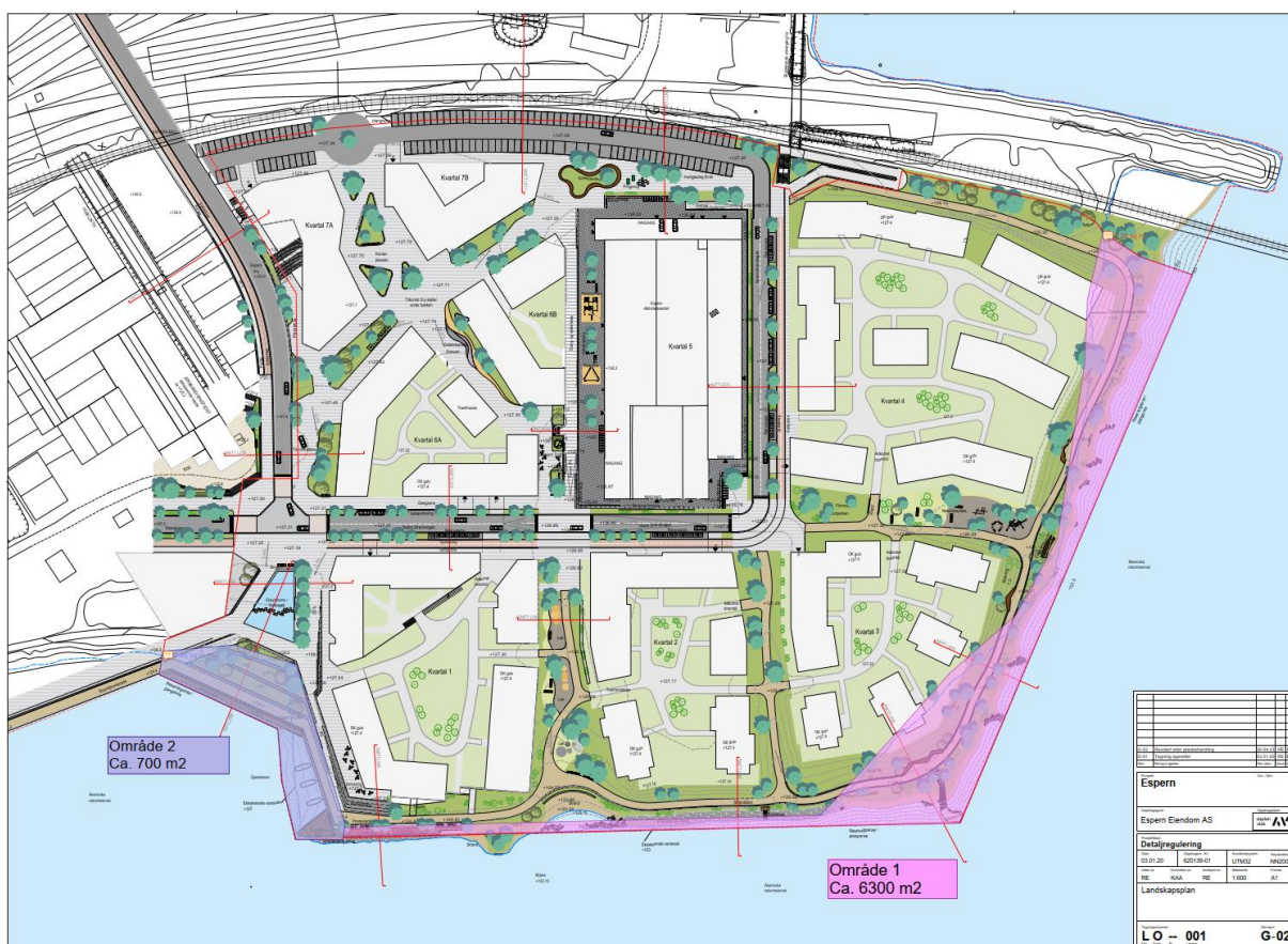
Figur 1-9: Landskapsplan for detaljregulering av Espern illustrerer de to utfyllingsområdene 1 og 2. Område 2 grenser mot og overlapper mot Bane NOR Eiendom AS sitt tiltaksområde og har andre grunnforhold (mer leire og silt), enn område 1 som domineres av stein og berggrunn. Plankartet ligger med høyere oppløsning i vedlegg 1.
