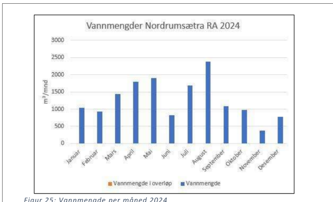
Figur 5-3: Avløpsmengde pr måned for 2024. Hentet fra årsrapport for Nordrumsætra renseanlegg 2024 (Driftsassistansen for vann og avløp i Oppland).
