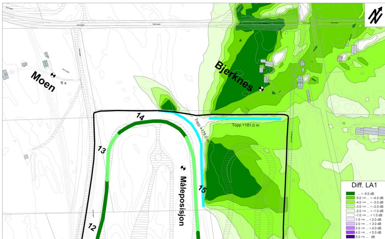
Figur 4 Beregnet differanse i maksimalt støynivå L_{A1} fra førerutviklingskurs med bil på bane 1 og 2 med foreslåtte støyskjermingstiltak vist med turkise linjer og angitte høyder. Differansen er beregnet som situasjon uten tiltak minus situasjon med tiltak, og viser reduksjon i maksimalt støynivå støyskjermingstiltakene vil kunne gi.
