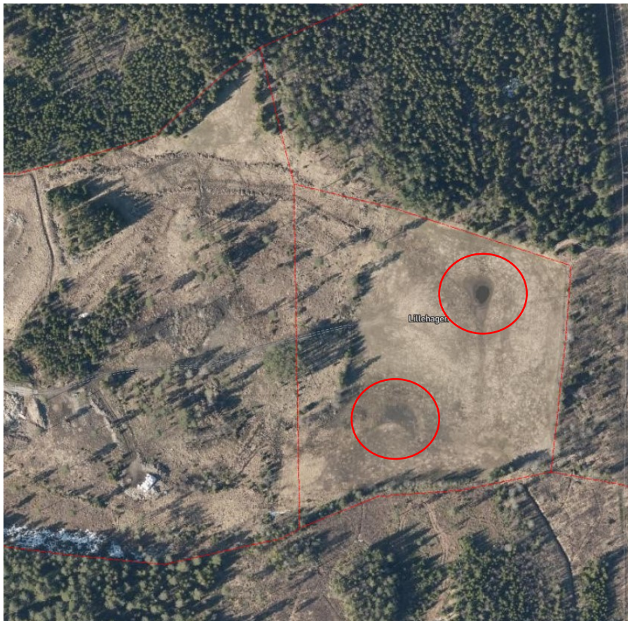
Figur 7-19: Det dyrkede arealet på eiendommen Lillehagen har dårlig drenering. Rød ring indikerer areal med synlig overvann, samt et areal hvor det har vært en dam tidligere.
