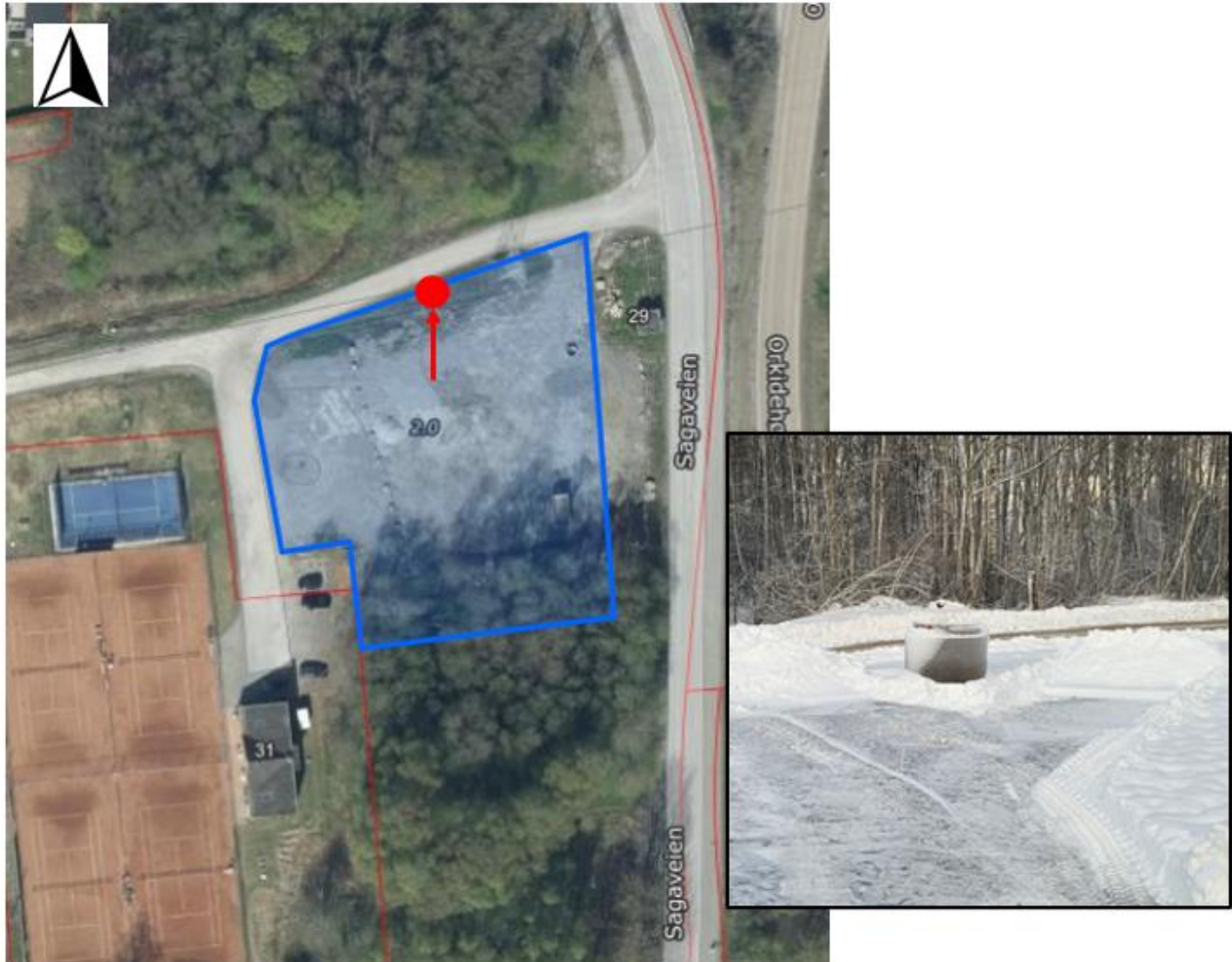
Figur 1: Oversiktskart over snødeponiet på Mjøndalen med utbredelse vist med blå skravur. Rød sirkel viser plassering av prøvetakingsrøret. Bildet til høyre viser at prøvetakingsrøret er plassert inne i en betongkum.
