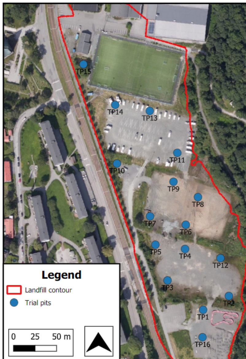
Figur 4-3: Oversikt sjaktpunkter som inngikk i prøvegravingen som ble utført sommeren 2021.
