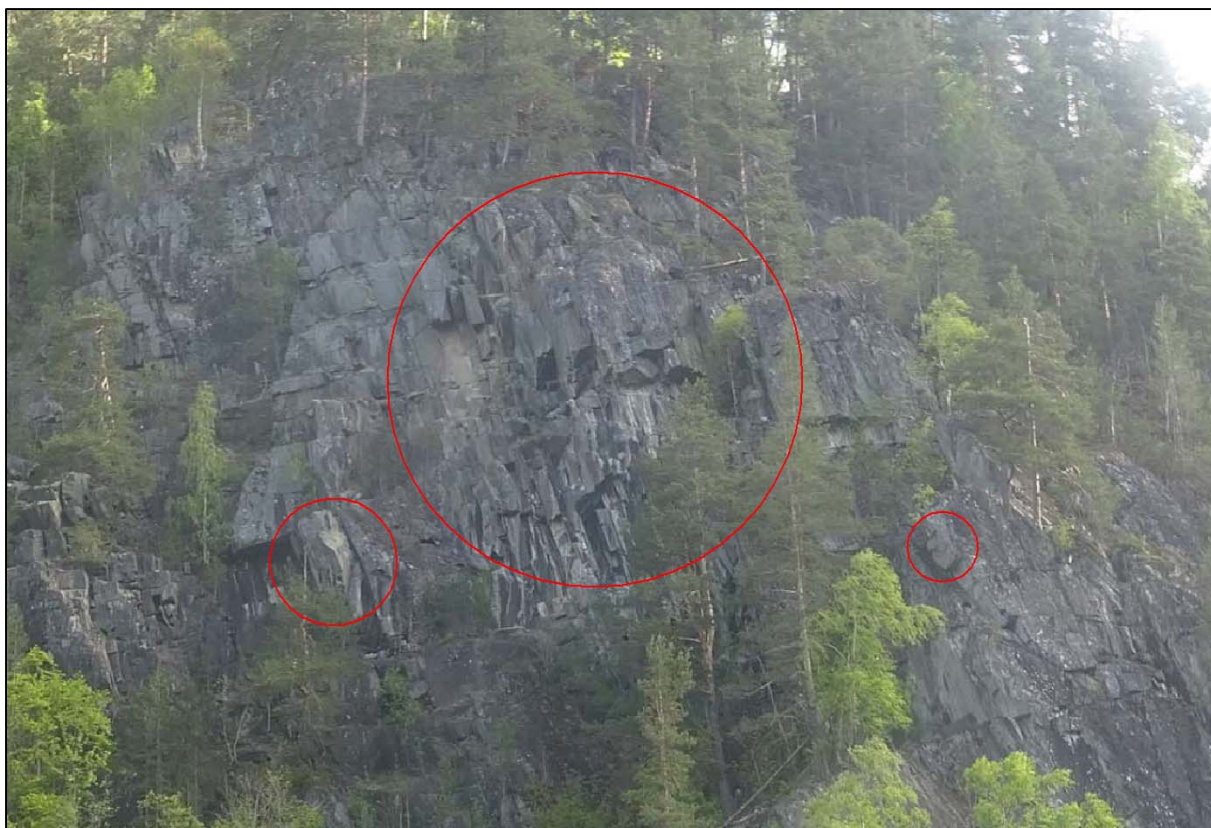
Foto 3. Eksempler på bergpartier eller enkeltblokker som tolkes som mulig ustabile, indikert med røde sirkler.
