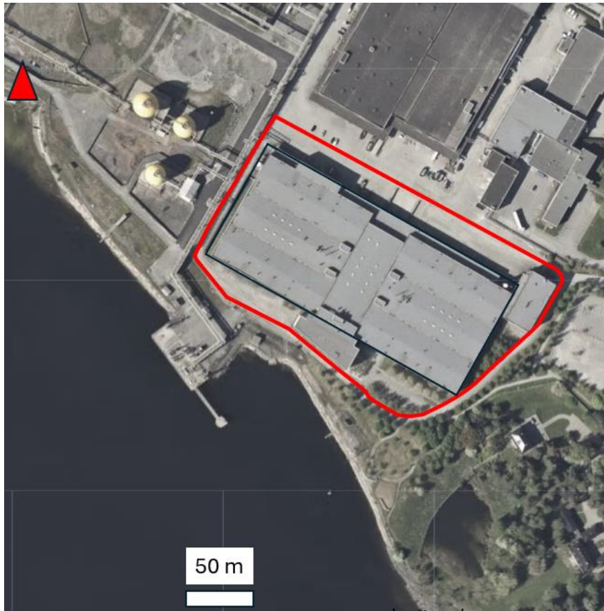
Figur 22: Beliggenhet av den nærmeste overvåkingsbrønnen 902 (vist med rødt triangel) av industriparken, med hensyn til undersøkelsesområdet, avgrenset med rød linje. Brønnen har liten relevans for undersøkelsesområdet, og er mest sannsynlig tidevannspåvirket, og dermed viser lavere konsentrasjoner av eventuelle forurensningsstoffer enn upåvirket grunnvann lenger inn mot land.
