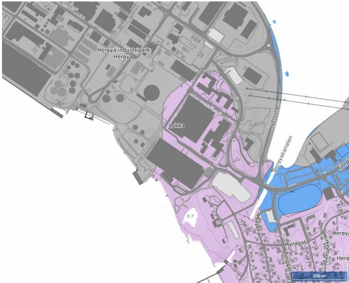
Figur 4: Løsmassegeologisk kart rundt undersøkelsesområdet. Undersøkelsesområdet er omtrent i midten av figuren. Herøyas opprinnelige naturlige løsmasser er mest borte / tildekket, utfylte masser (grå farge) er mest vanlige på hele øya. I den sørlige delen rundt Herøyakanalen dukker bartfjell opp eller er i meget grunn dybde (vist med rosa farge). Den opprinnelige leire løsmasse er vist med blå farge. Kilde: www.ngu.no
