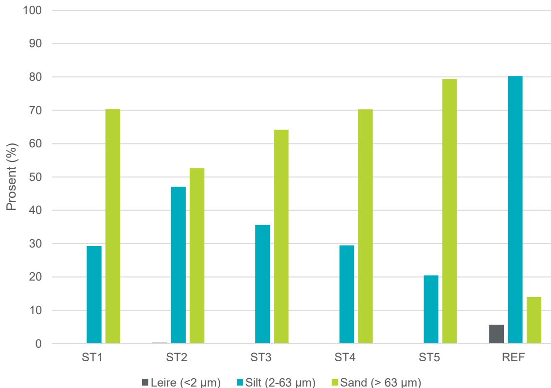
Figur 4-3: Kornstørrelsesfordeling på hver prøvestasjon (ST1-ST5) og referansestasjonen (REF).
