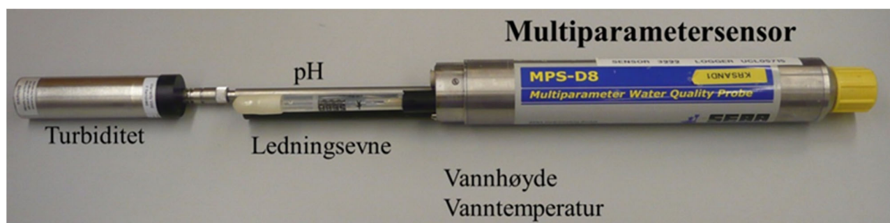
Figur 3.1. Multiparametersensor for automatisk overvåking av vannkvalitet.
