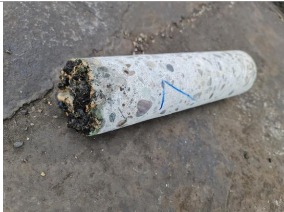
Bilde 12: Betongprøve fra prøvepunkt BORR 07-01.
