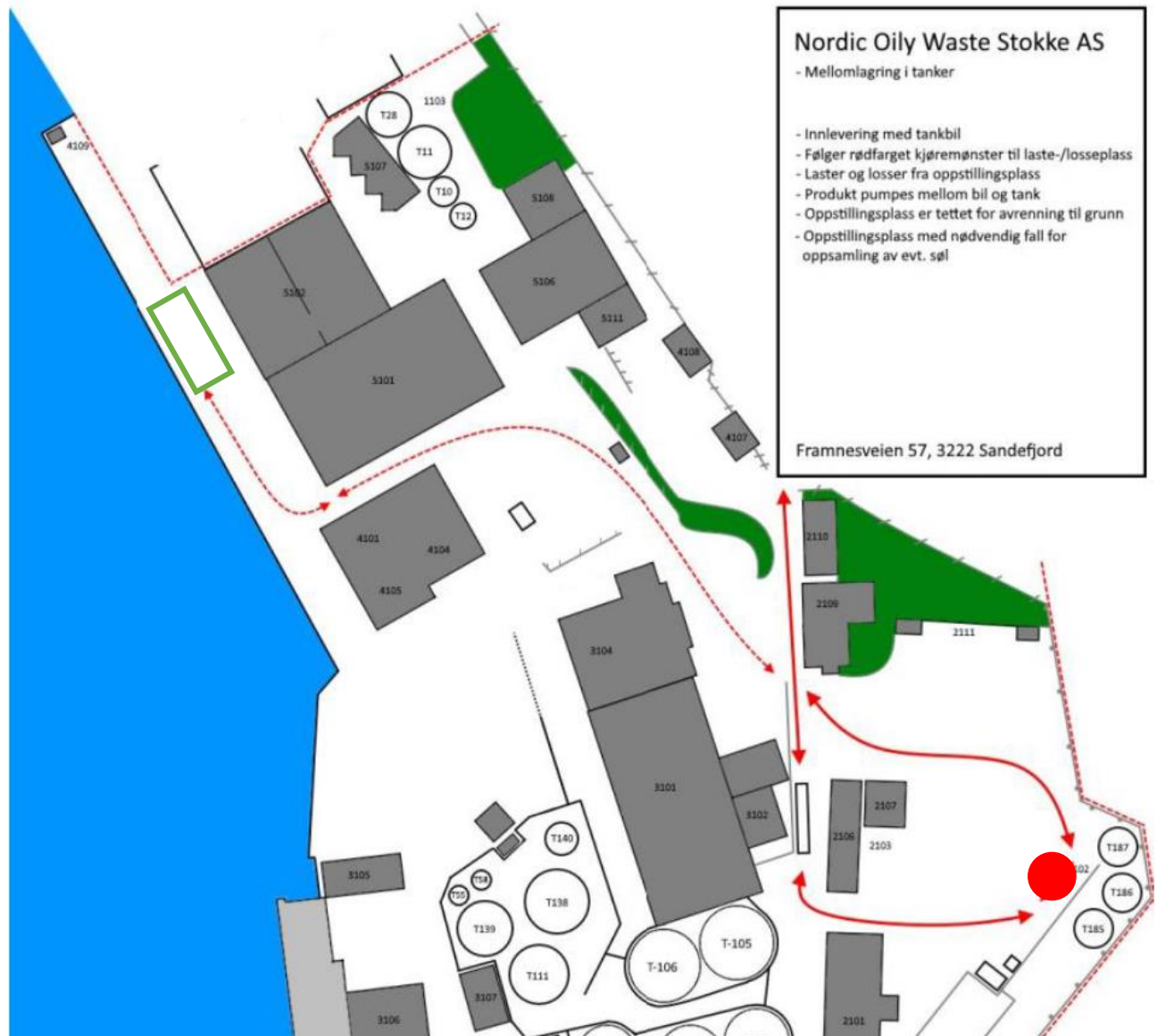
Figur 7 Kjøremønster for tankbiler på JNP. Røde heltrukne linjer indikerer transport til og fra tankgård; rød sirkel indikerer lasse/losseposisjon; stiplet linje indikerer transport til og fra langkaia; grønt rektangel indikerer lasteplass for omlasting til/fra tankbil og -skip.
