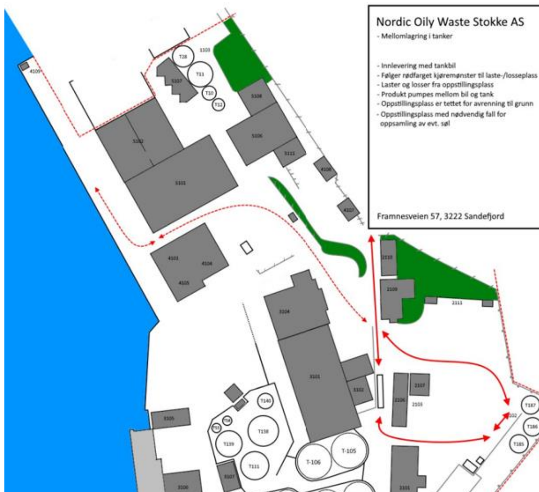
Figur 3-3 Kjøremønster for tankbiler mellom kai og lagertanker
