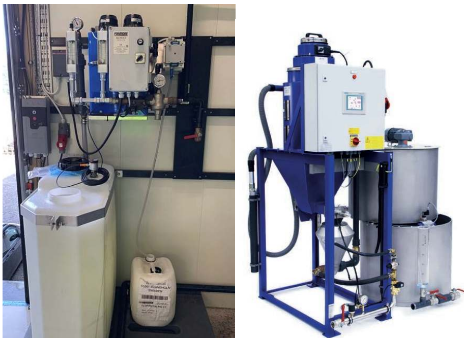
Figur 4-10. Polymerbereder for flytende polymer fra Polymore (den lille 25l kannen er polymerkannen) til venstre og polymerbereder for tørrpolymer fra Tomal (25 kg småsekker) til høyre.
