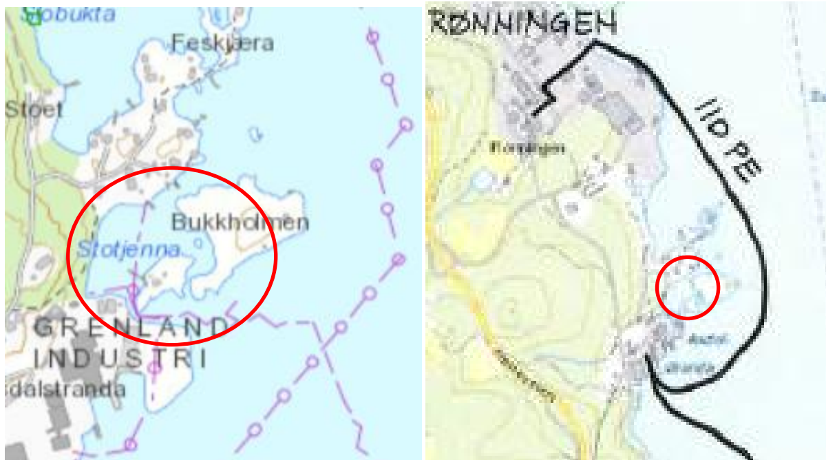
Figur 7. Bilde til venstre viser ledninger og kabler fra ENC fra Kystverkets kart på nett. Bilde til høyre viser vannledning for forbruksvann fra kommunal nett, fra rapport «Områderegulering Frier Vest, vurderinger vann- og avløp» for prosjektet. Området for utfylling i fase-1 er vist med rød sirkel på begge bilder.
