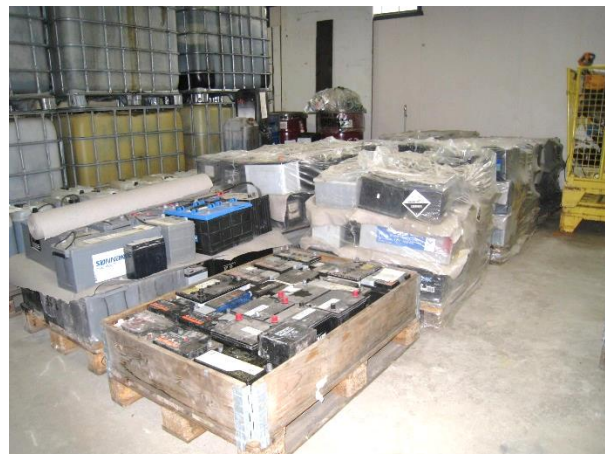
Bilde 2 viser emballering og lagring av uskadede blyakkumulatorer.
