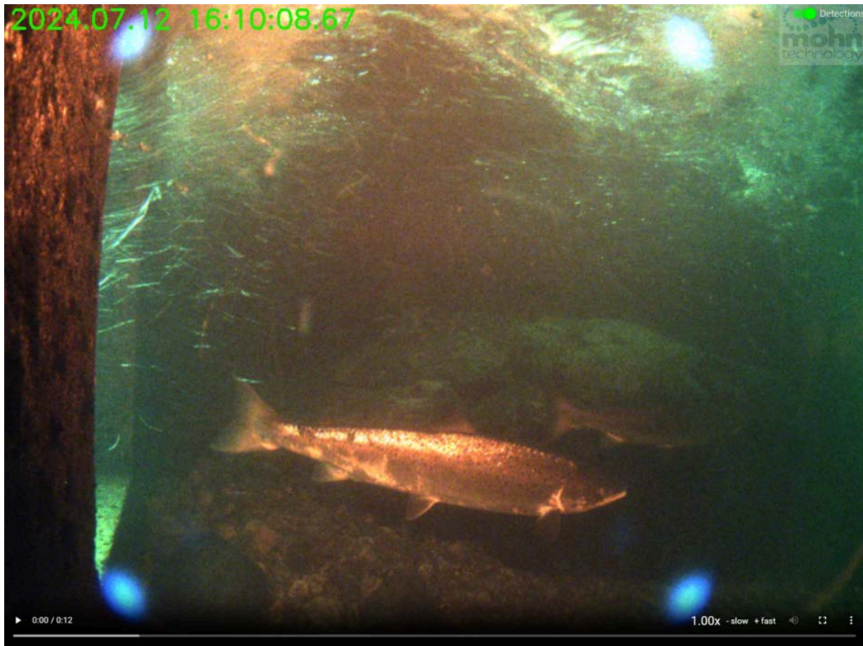
Figur 1: Skjermdump som viser hele synsfeltet. Fisken blir talt når den entrer kummen gjennom inngangen til venstre i bildet. Elven renner fra høyre mot venstre.
