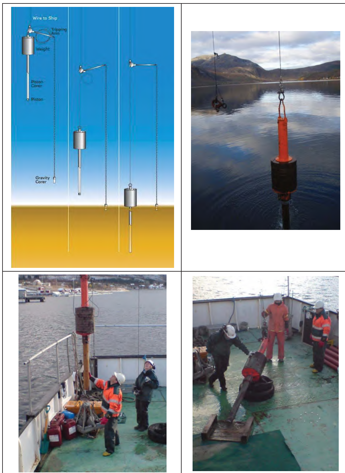
Figur 3 Prinsippskisse for prøvetaking med «pistoncorer», samt Multiconsults «pistoncorer» i bruk.
