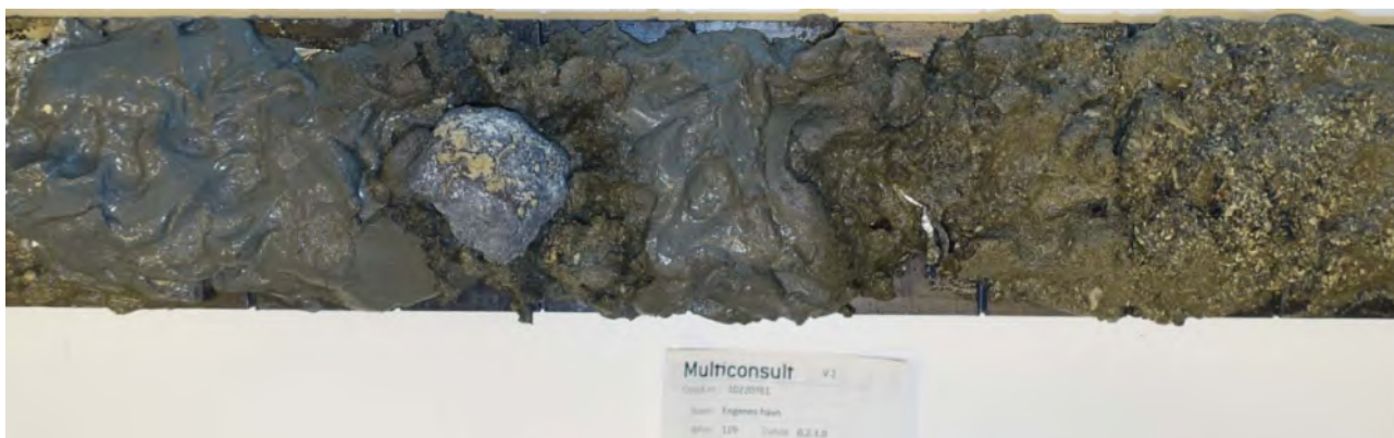
Figur 4-3: BP.119, 0,2-1,0 m. Viser lagdelingen med kvikkleire.
