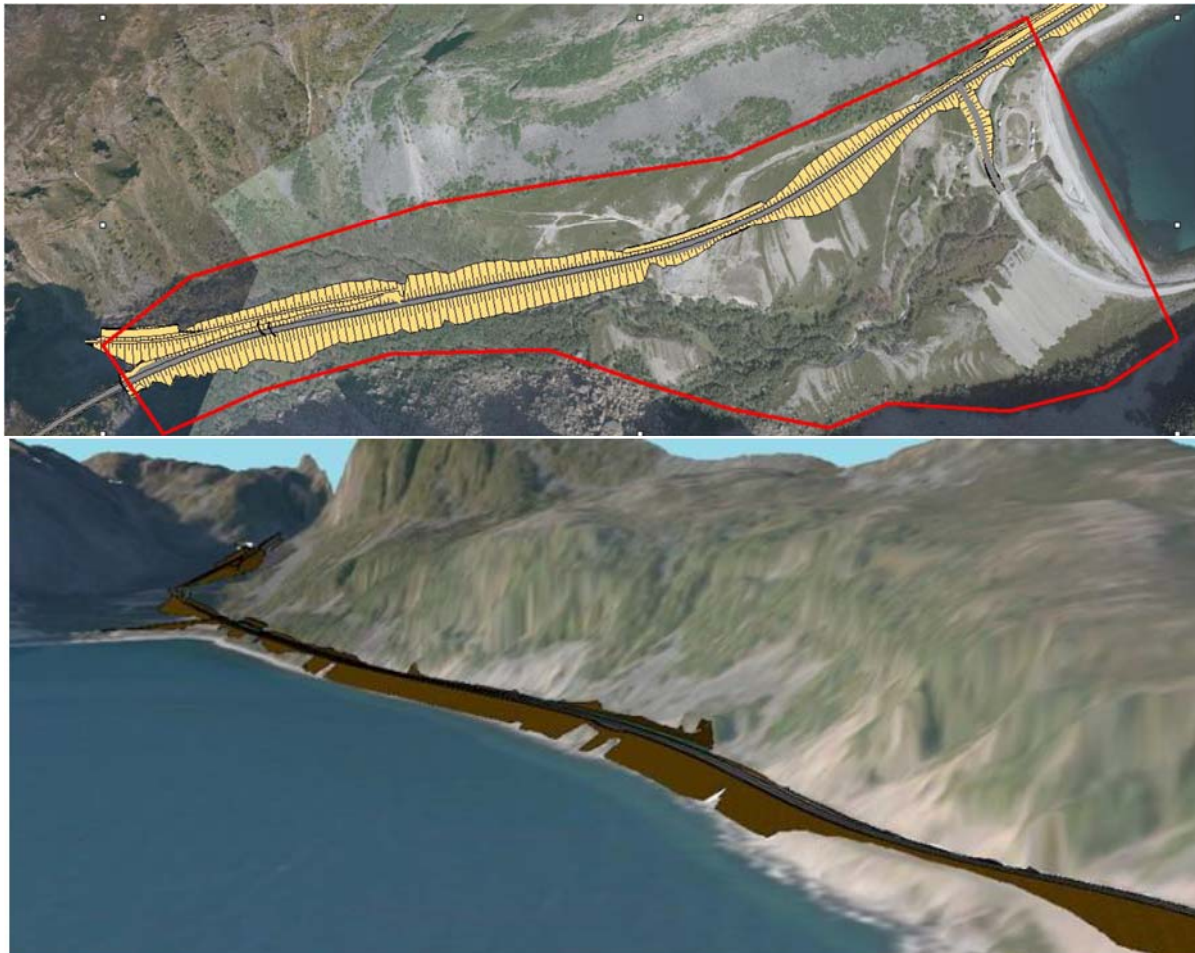
Figur 3: Oversiktskart og modell som viser veifylling der all sprengstein fra tunnelen skal benyttes (Statens vegvesen, 2016).
