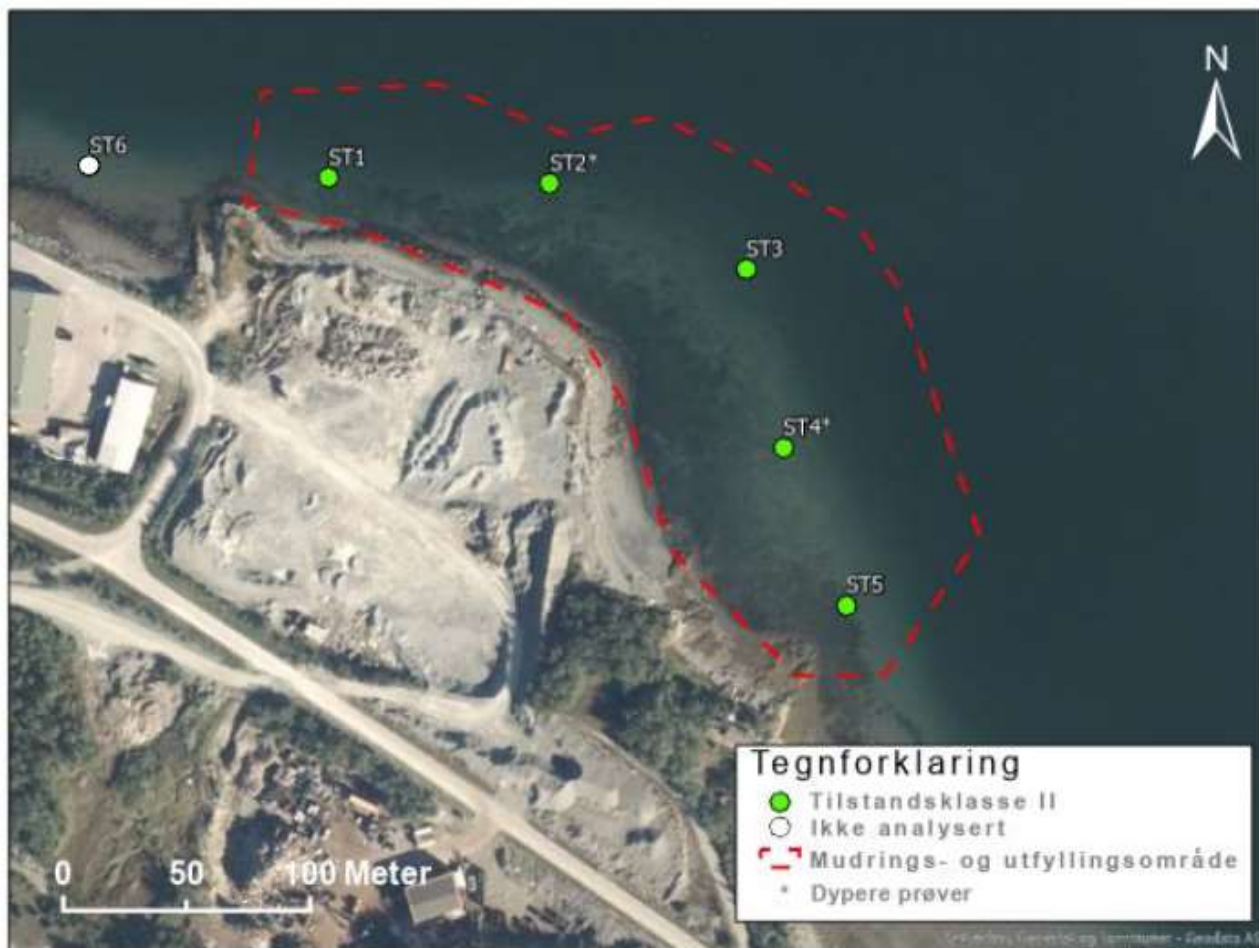
Figur 7 Undersøkt område i Bergneset havn i 2019. Prøvestasjoner er markert med tilstandsklasse II som er høyeste påviste tilstandsklasse for samtlige miljøgifter. Prøvestasjoner med analyserte dypere prøver med tilstandsklasse II er markert med stjerne. Utfylling- og mudringsområdet er merket med rød stiple linje.
