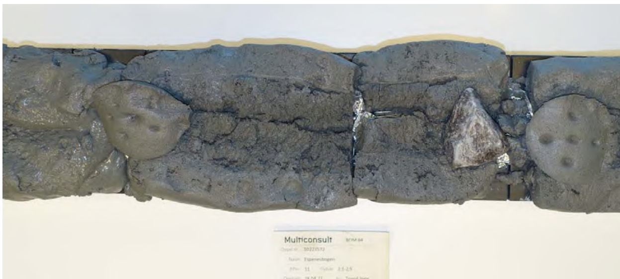
Figur 4-3: Borpunkt 11 fra 2,1-2,9 meter. Omrørt skjærfasthet varierer mellom 0,47 og 1,72 kPa.
