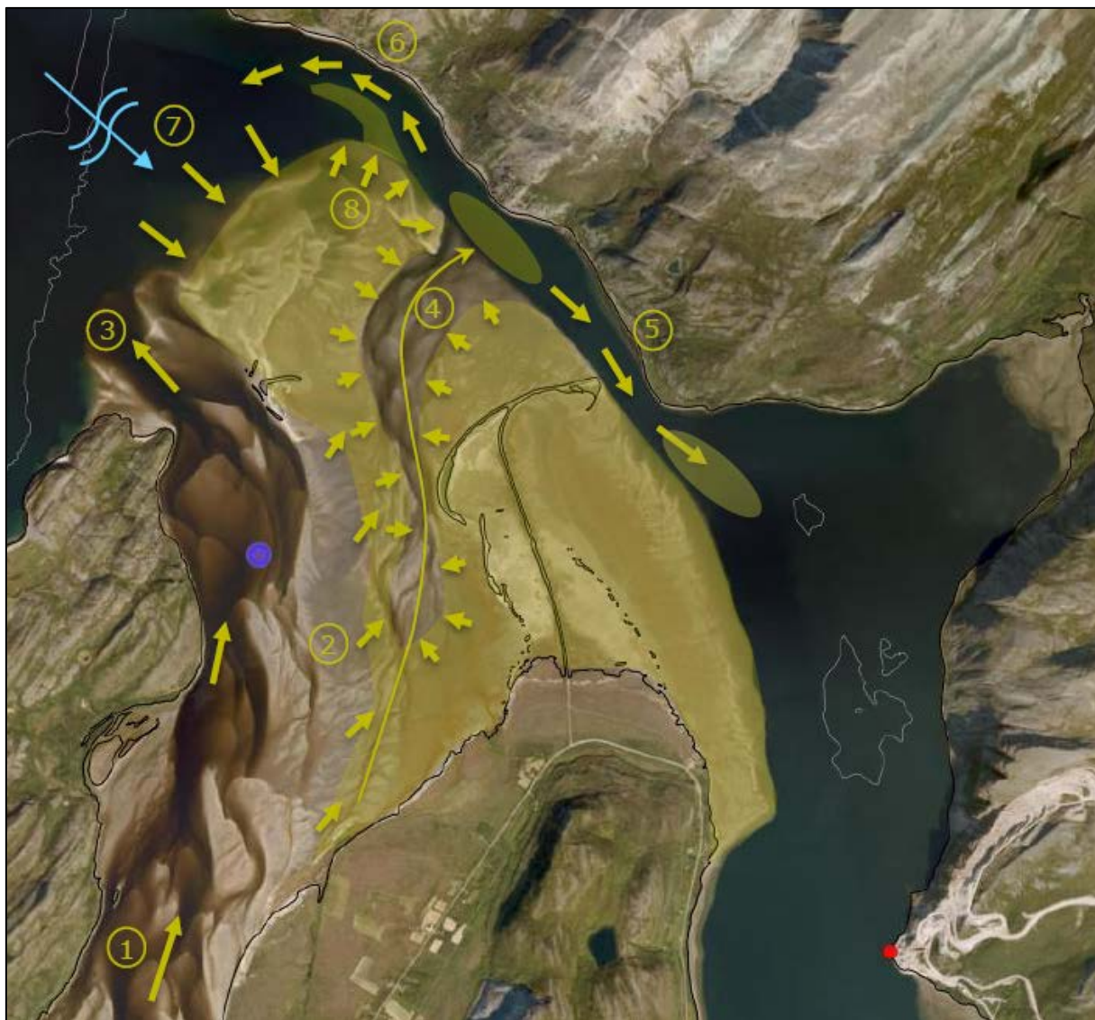
Figur 4-1. Kvalitativ skisse for sedimenttransport i Leirpollen. De gule pilene viser retning for sedimenttransport (gjennomsnittlig), de fargede områdene viser deponeringsdominerte områder, og den blå pilen viser bølger og vind fra fjorden. Hovedkilden til sedimenter er Tanaelva (1). En del av disse sedimentene strømmes direkte ut i fjorden (3), de andre transporteres langs kontakten med tidevannsfalten (2). Disse sedimentene deponeres i tidevannsfalten og, med tiden, transporteres til avløpet og deretter til tidevannskanalen (4) ved lavvann. Derfra vil sanden fordeles langs tidevannskanalen i to motsatte retninger: ut mot fjorden (6) eller inn i Leirpollen bukta (5). Bølger og vind transporterer sand sydover mot tidevannsfalten (7). I nærheten av sandbarrieren kan det skje noe sandtransport mot øst (8) som skaffer sediment slik at sandbarrieren kan vokse (Dr. Tech. Olav Olsen AS, 2017). Modell hentet fra Dr. Techn. Olav Olsen (Dr. Tech. Olav Olsen AS, 2017).
