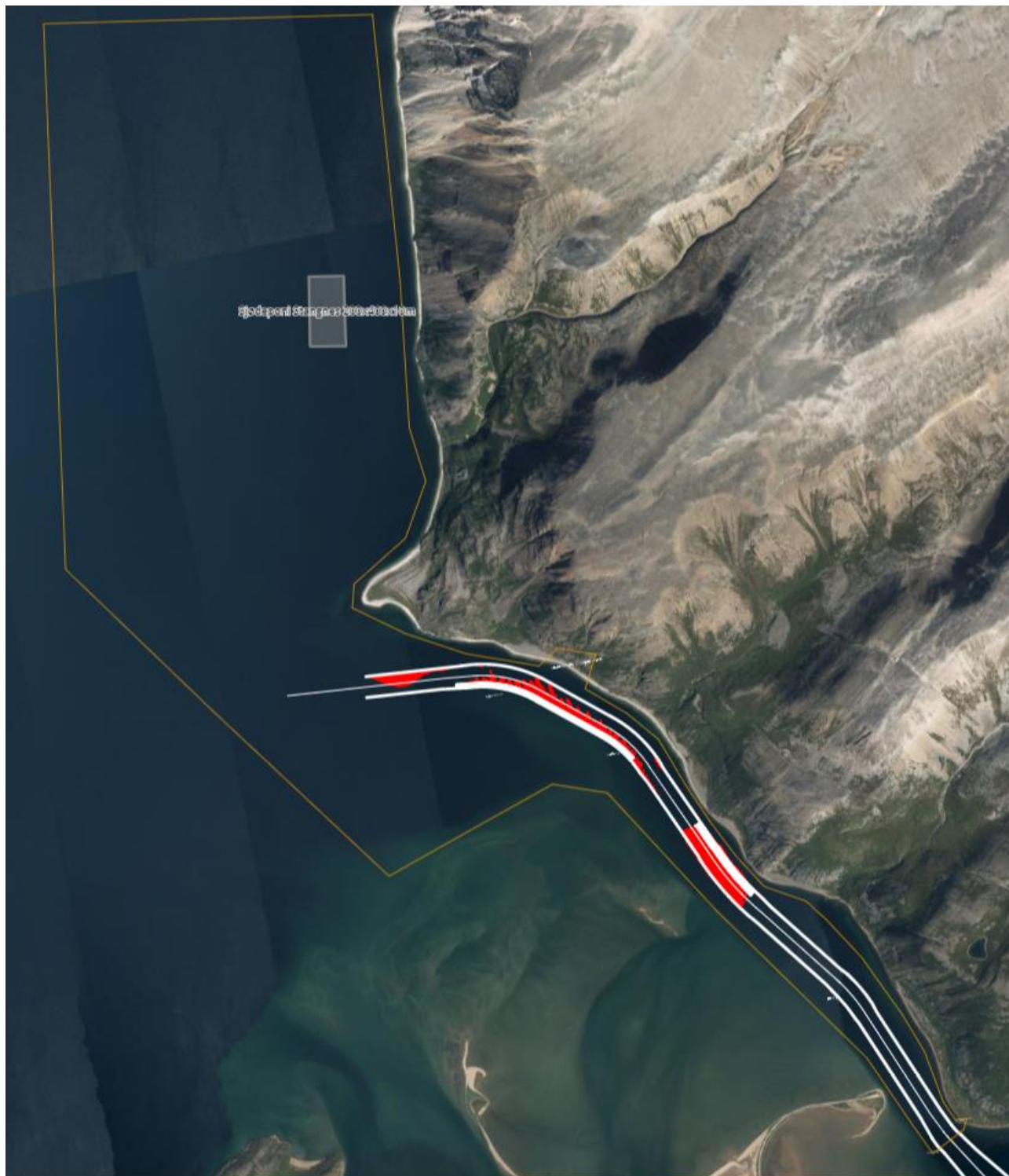
Figur 2-1). Entreprenør er ikke valgt slik at det per i dag ikke er avklart hvilket utstyr som skal benyttes til mudringen eller metode for deponering av massene. Med bakgrunn i stort volum mudringsmasser, vil utdypingen mest sannsynlig bli utført med 2 rigger med bakgraver eller med hopper dredger. Mudringsmassene vil trolig fraktes med båt med åpning i bunn eller med splittlekter til sjødeponiet.
