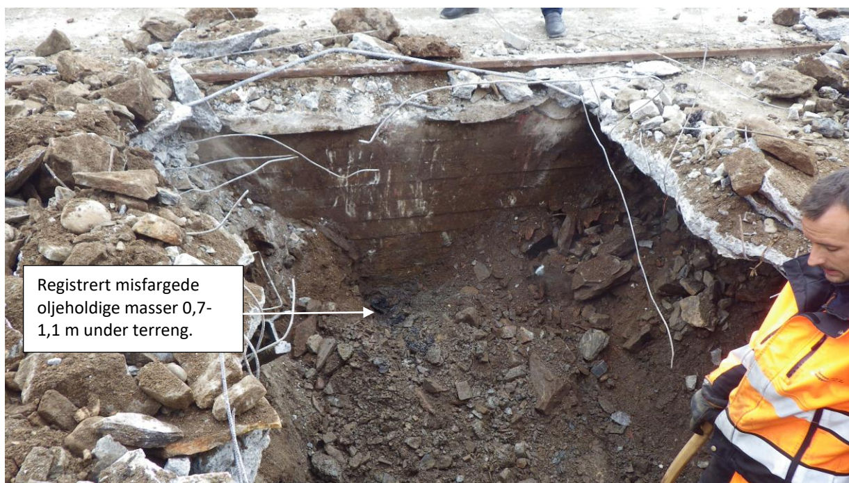
Figur 7: Prøvegrøp 7. Under betongdekket ble det registrert fyllmasser av stein, grus og sand over berg. Like over berg (0,7-1,1 m dybde) var det fuktige masser med misfarging og lukt av olje i massene. Foto: Multiconsult mai 2019.
