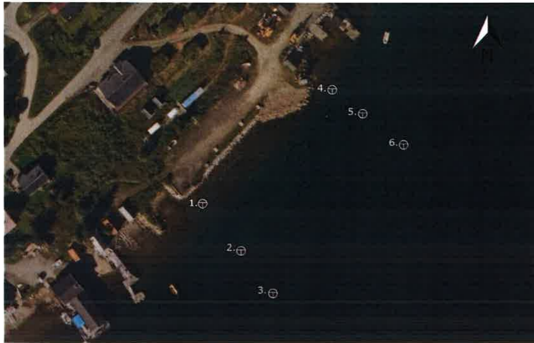
Figur 2. Borplan geotekniske grunnundersøkelser. Kilde: Rambøll 2020.
