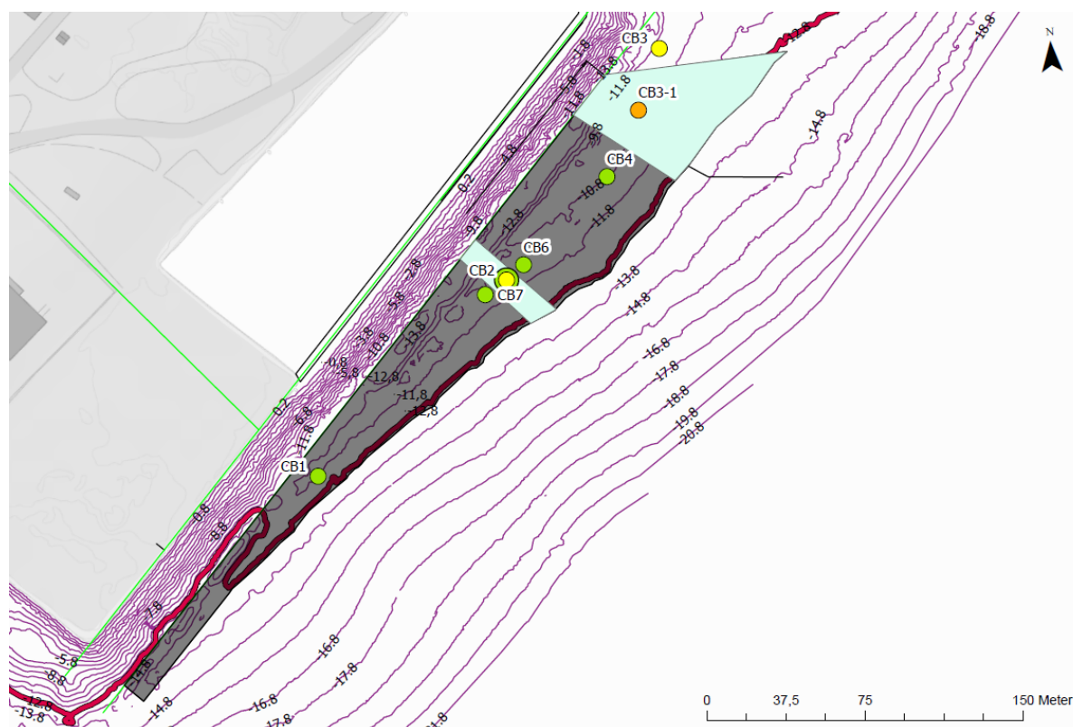
Figur 5-1: Lysegrønne områder markerer antatt forurensete masser ned til 0,5 m sedimentdybde.
