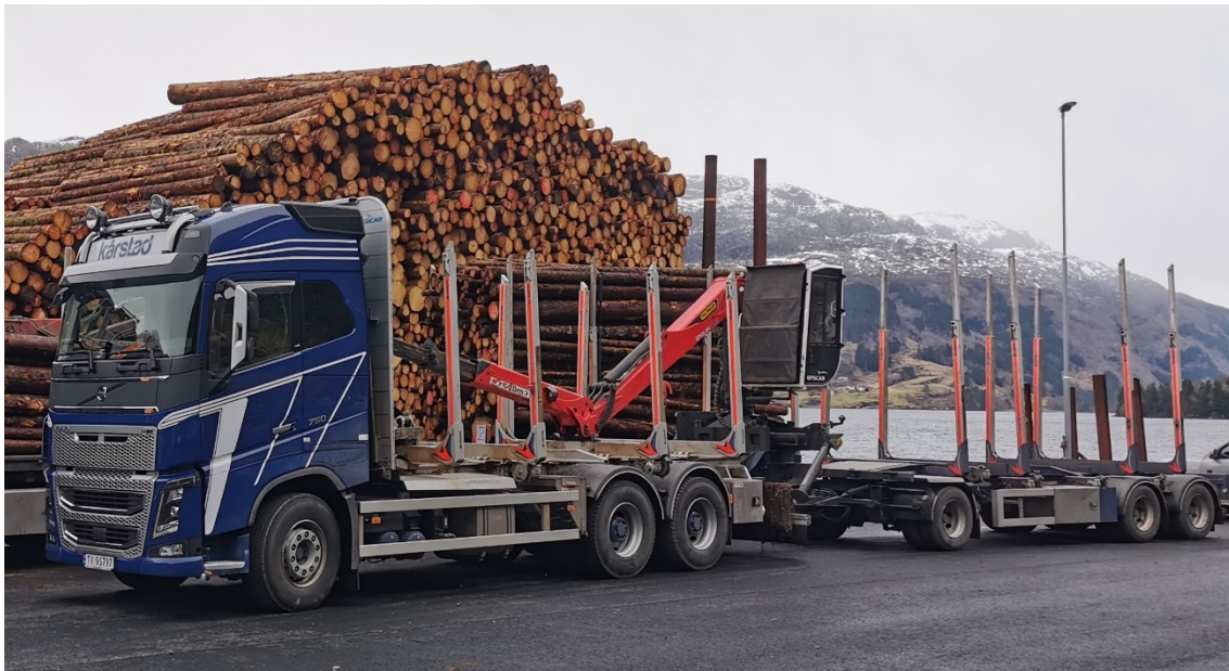
Figur 1.2: 3-akslet tømmerbil med 3-akslet tilhenger (korthenger). Foto: Torkel Hofseth.
