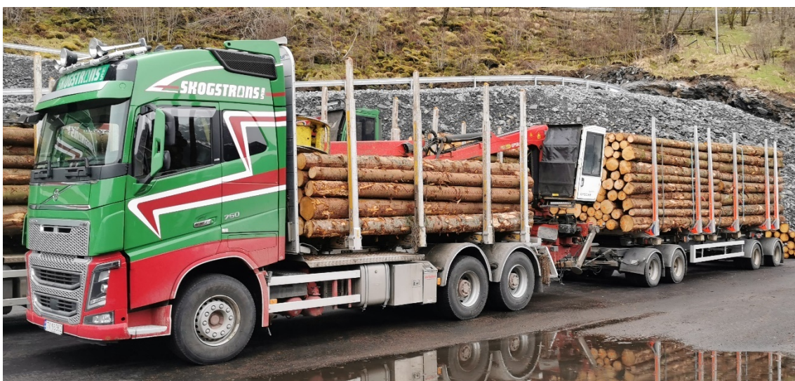
Figur 1.3: 3-akslet tømmerbil med 4-akslet tilhenger (langhenger). Foto: Torkel Hofseth.
