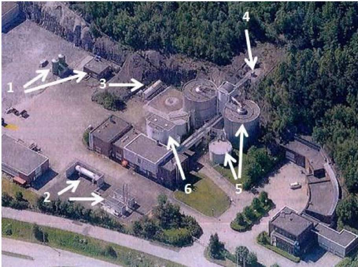
Figur 4.3. Plassering av enhetene i IVAR sin gass og pellets produksjon. Tallene refererer til teksten ovenfor.
