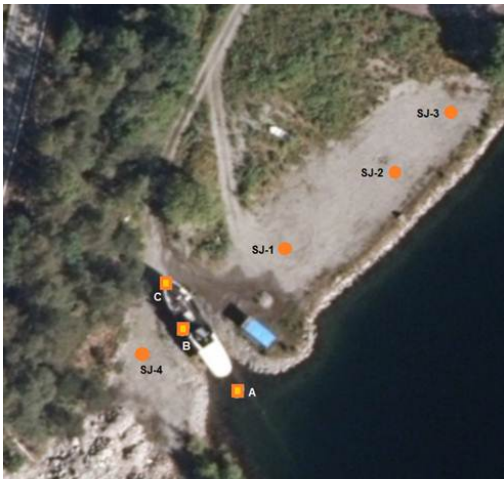
Figur 3. Sjaktpunkt vises med runding og forbokstav SJ i punkt navn. Overflateprøver samlet inn for hånd er merket med firkant og navn A-C.
