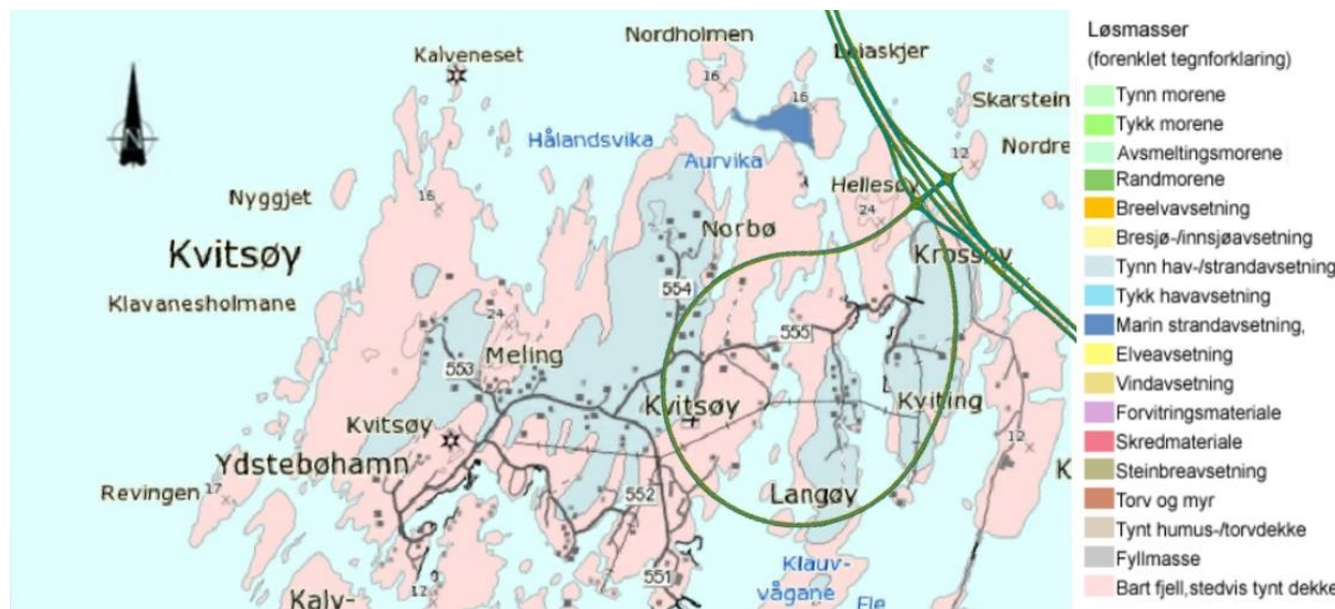
Figur 7 Utsnitt fra NGUs løsmassekart [11] med inntegnet tunneltrasé
