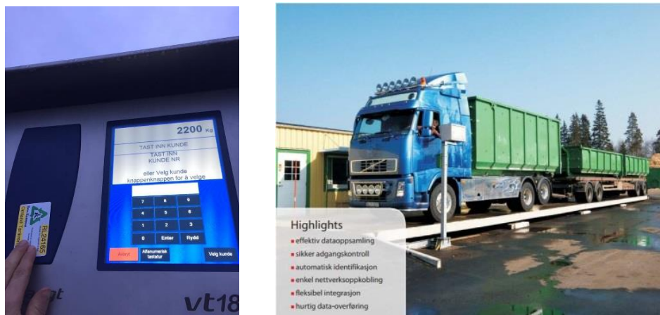
Figur 2: Anleggets besøkende må ha sjåførkort med ID for å ha tilgang til anlegget.
