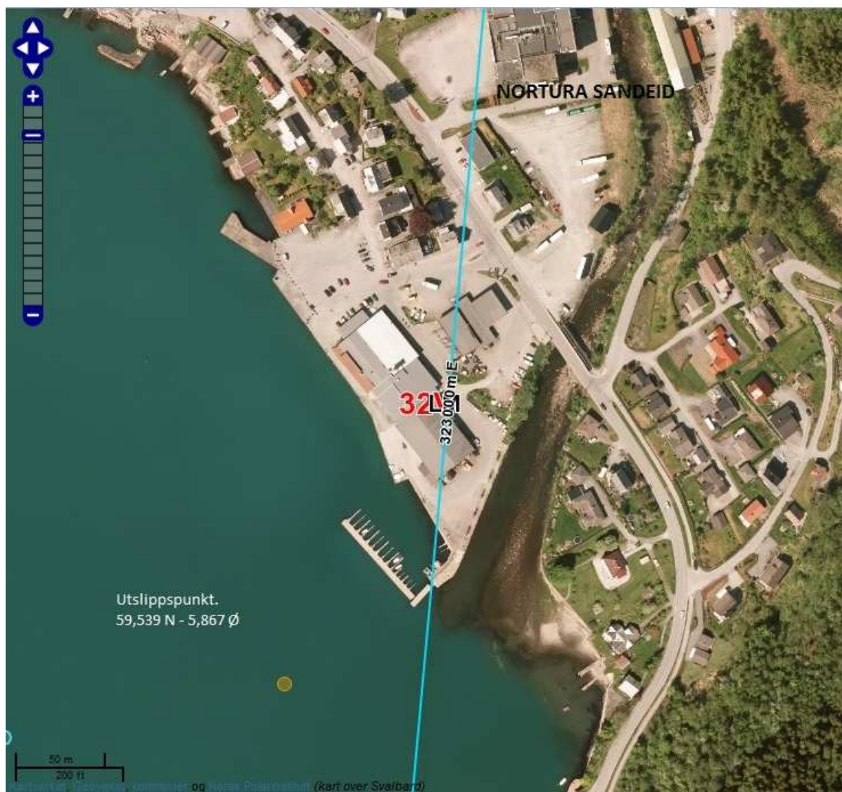
Figur 3. Nortura Sandeid – utslippspunkt for alt avløp, unntatt overvann
