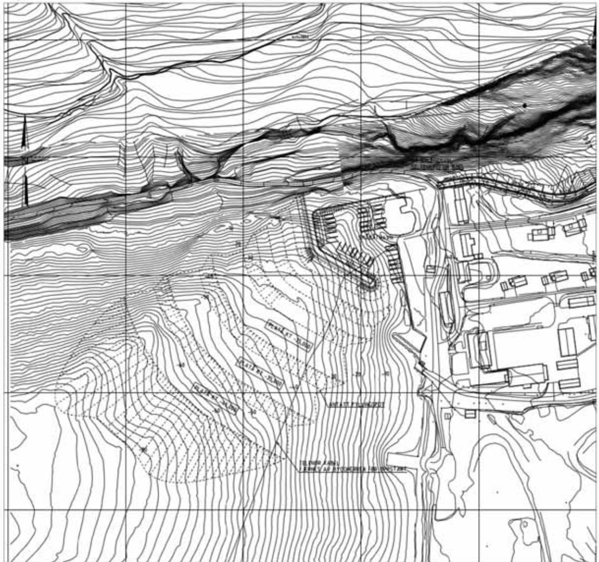
Figur 3-2 Plantegning av planlagt molo og småbåthavn med dybdekoter og støttefylling markert. (Kilde: Norconsult 09.12.13 – vedlegg 4)
