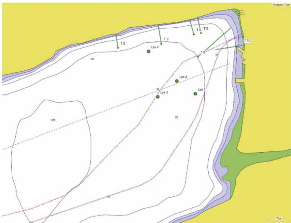
Figur 3: Undersøkt område i planområdet. Punktene Lys 1-4 ble filmet rundt punktet, mens punktene T5-T10 er startpunkt for videotransekter som er markert med grønn linje.
