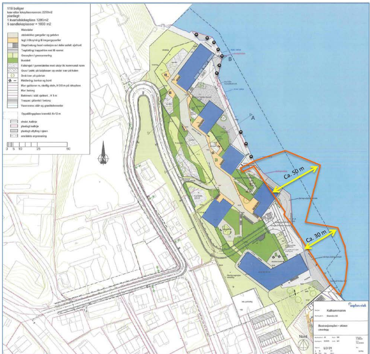
Figur 2 - Skisse av utbyggingsområdet (Asplan Viak, 2013). Planlagt utfyllingsområde er skissert med orange linjer, mens planlagte pelepunkt direkte på dagens sjøbunn er vist med sorte sirkler.
