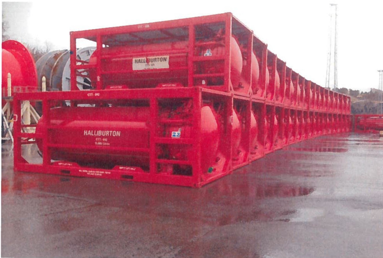
Fig C CTT tanker er ca 6 m lange og 2,4 m brede. Lastekapasitet er 22-23 tonn. De vil kreve et areal på ca 100 m 2 .
