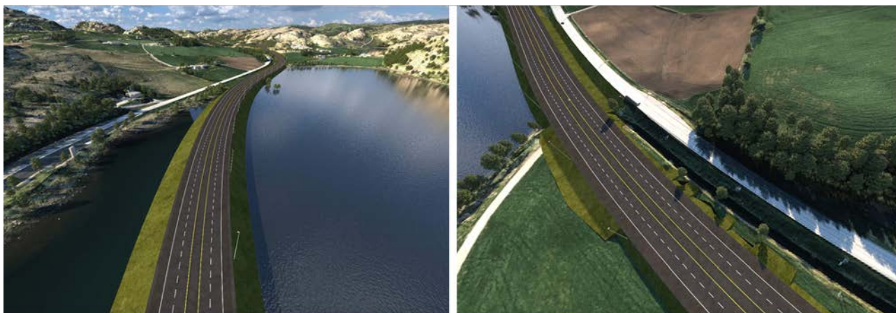
Figur 6-4: Ny E39 på fylling midt i Ytra Kydlandsvatnet og kanalisert utløp.
