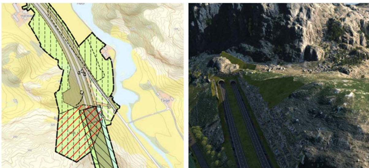
Figur 6-16: Tunnelutløp og ny E39 nordover mot Skurve og Klugsvatnet, parallelt med Auestadåna. Utsnitt fra plankartet viser blant annet at det er regulert inn areal til renseløsning for vaskevann fra tunnel ved dagens E39 og riggområder ved tunnelutløp ved elva.
