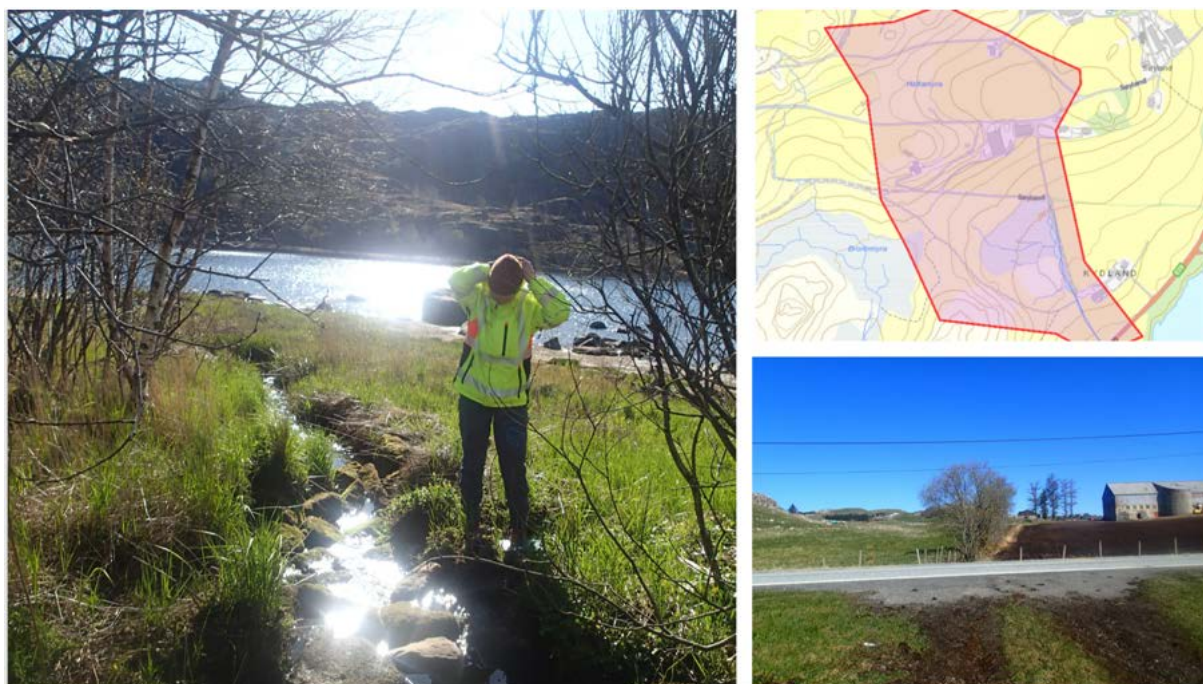
Figur 6-3: Liten bekk gjennom jordbruksareal som går i rør under dagens E39 og har utløp i nordre del av Ytra Kydlandsvatnet. Nedbørfeltet til bekken er vist på kartet øverst til høyre.
