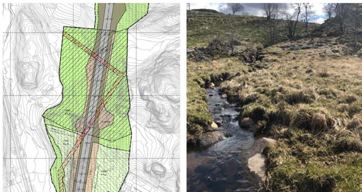
Figur 6-8: Utløpsbekken fra Svartatjødn legges i rør under ny vei.
