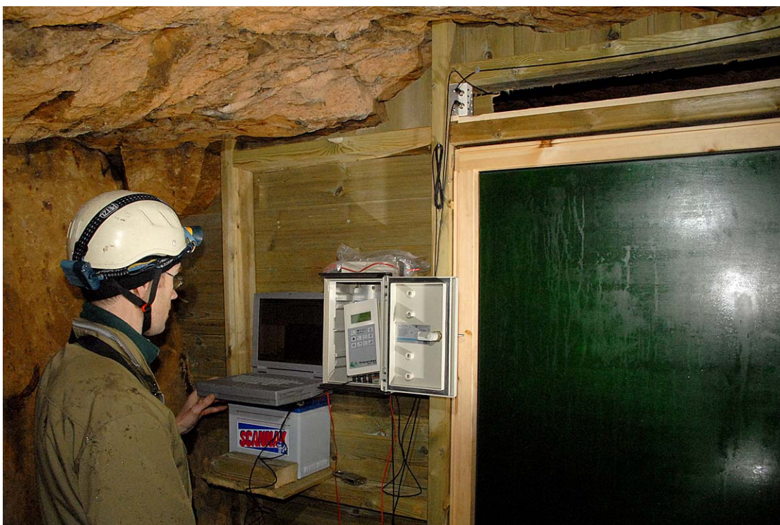
Figur 13. Nedlasting av data fra overvåkningsenhet. Logger vises i midten, mens infrarødsensorene befinner seg øverst til høyre i bilde. Foto: Jeroen van der Kooij.
