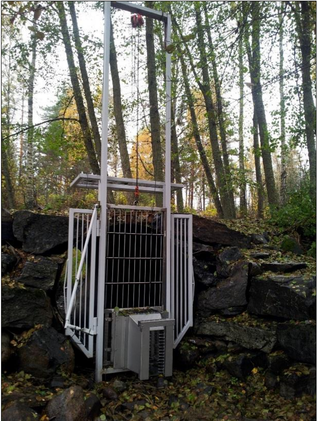
Fig. 7. En talje festet i toppen av en stål-ramme gjorde at teller og grind kunne heves og senkes etter behov, f.eks. ved rengjøring.
