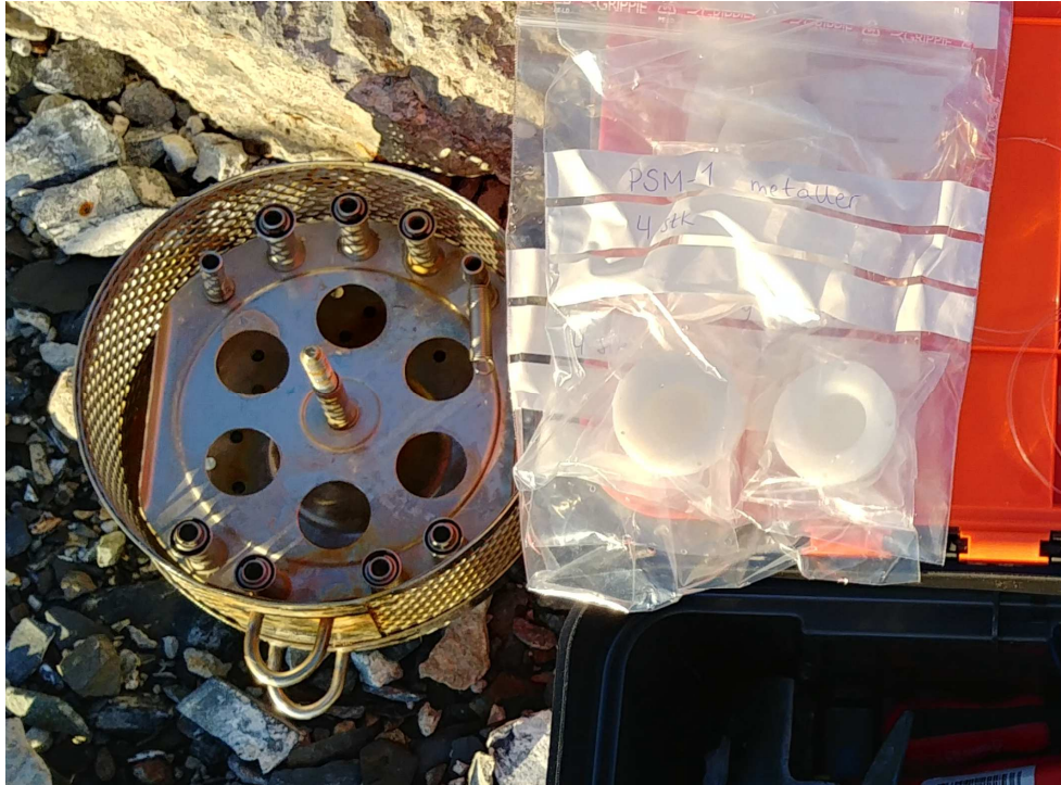
Figur 2: Bildet viser metallburet til SPMD-membranene (venstre) og DGT-prøvetakere (høyre, i plastpose).
