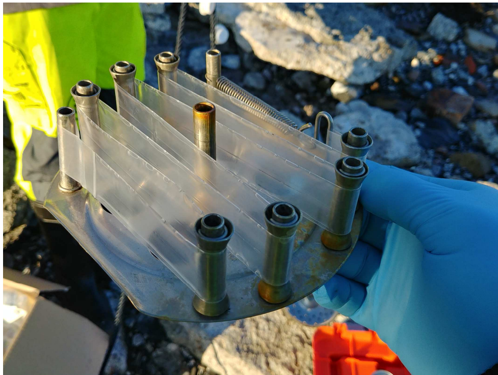
Figur 3: Bildet viser en SPMD-membran som blir montert og skal settes inn i buret vist til venstre i Figur 2.
