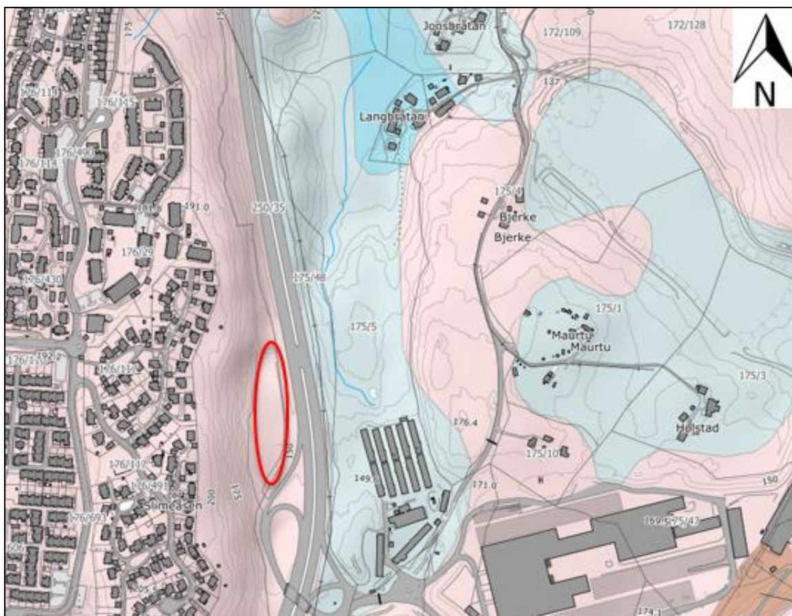
Figur 2-3. Utsnitt av NGUs kvartærgeologiske kart. Ifølge kartet skal E6 ligge omtrent på grensen mellom marine avsetninger og bart fjell (< 50 % løsmassedekke). Omtrentlig plassering av asfaltert flate i deponiet er markert med rød sirkel.
