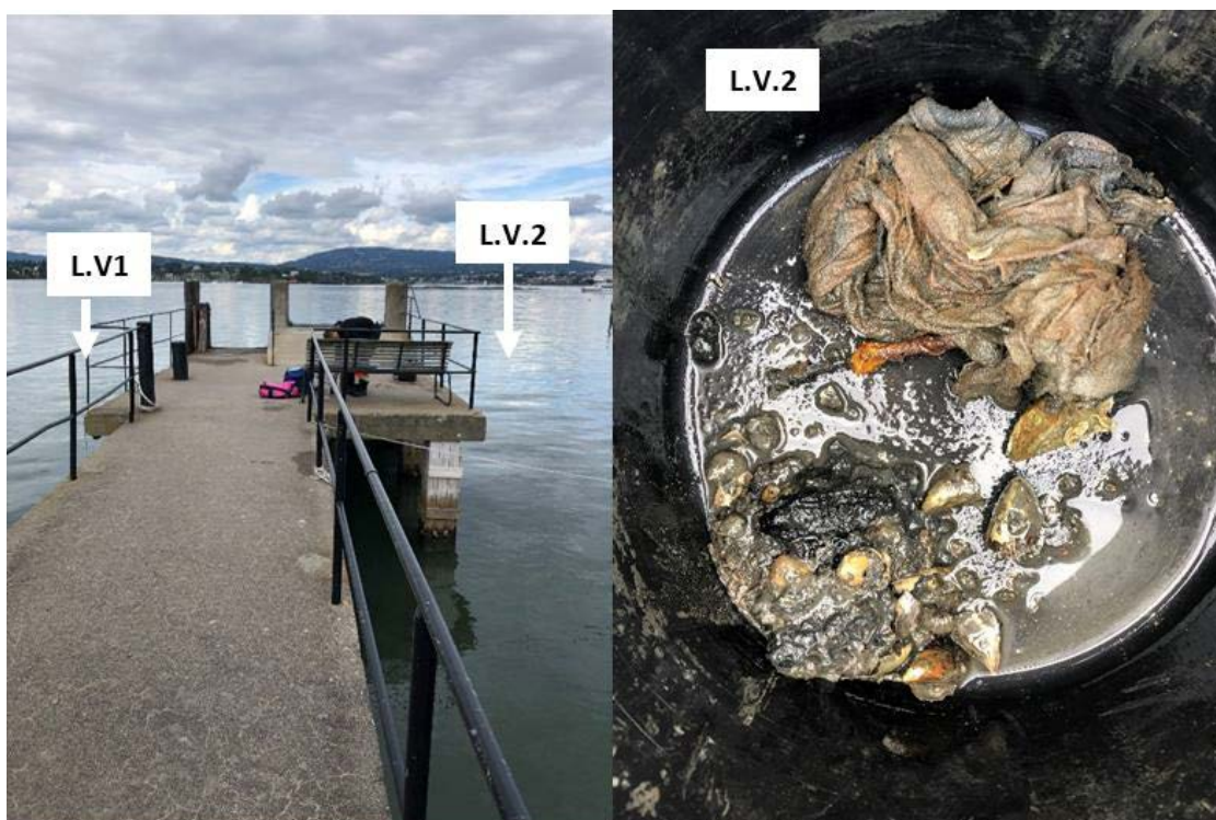
Figur 2-4: Venstre: Bilde av bryggen ved Lindøya Vest. Til høyre: Bilde av en grabbprøve hvor sediment ble drennert ut pga. inneholdt avfall ved L.V.2.
