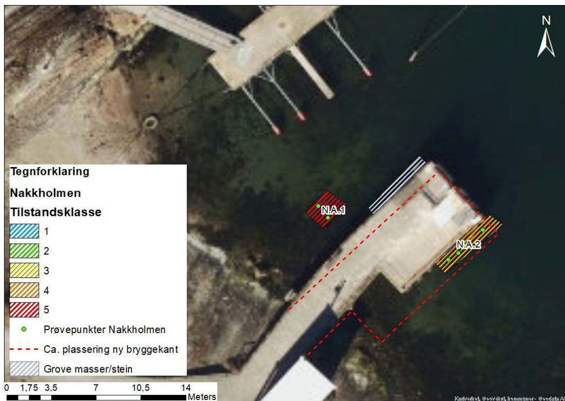
Figur 4-4: Påvist forurensing ved Nakkholmen. N.A.1 er forurenset innen tilstandsklasse 5 og N.A.2 er forurenset innen tilstandsklasse 4.
