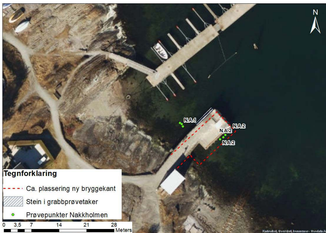
Figur 2-5: Kart viser plassering av de to prøvetakningsstasjonene N.A.1 og N.A.2 ved Nakkholmen. N.A.2 ble tatt ved bruk av grabb, og N.A.1 ble tatt med kjerneprøvetaker.
