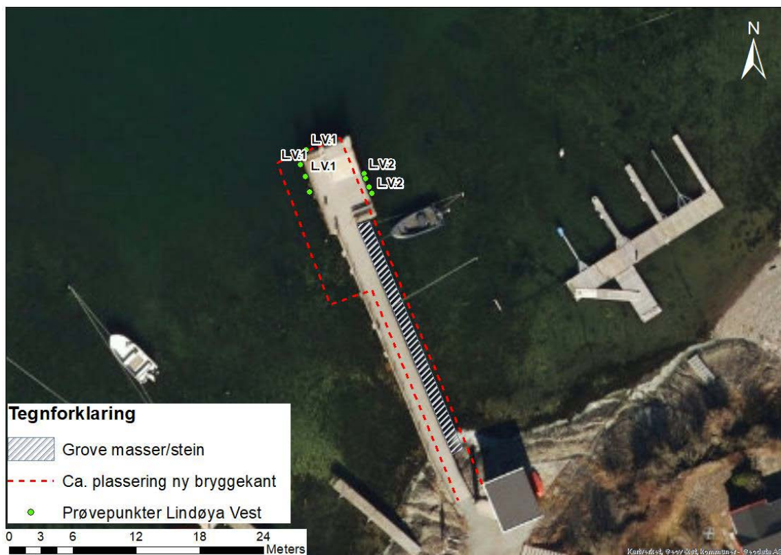
Figur 2-3: Kart som viser plassering av sedimentstasjonene ved Lindøya Vest. Området hvor det ikke var mulig å ta sedimentprøve pga. for mye stein er merket med grå farge
