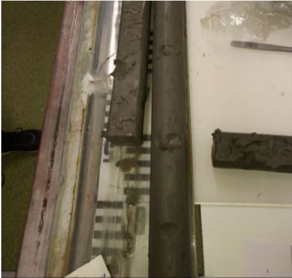
Figur 2 Borekjerne av bløt marine leire fra boring 104 på parkeringsplassen
